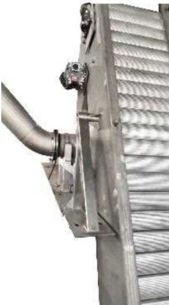
این آشغال گیر با استفاده از مکانیزم آشغال گیرهای مکانیکی زنجیری و نصب صفحات پرفوریت با مشبک بندی های ریزدانه یکی از کارآمدترین آشغال گیرهای ریزدانه می باشد. این آشغال گیر با بهرمند شدن از سیستم شستشوی خودکار و همچنین تنوع در دانه بندی گزینه مناسبی در پیش تصفیه و حذف پسماندهای جامد از فاضلاب کارخانه های نساجی کشتارگاه ها، روان آب ها و فاضلاب شهری می باشد.
